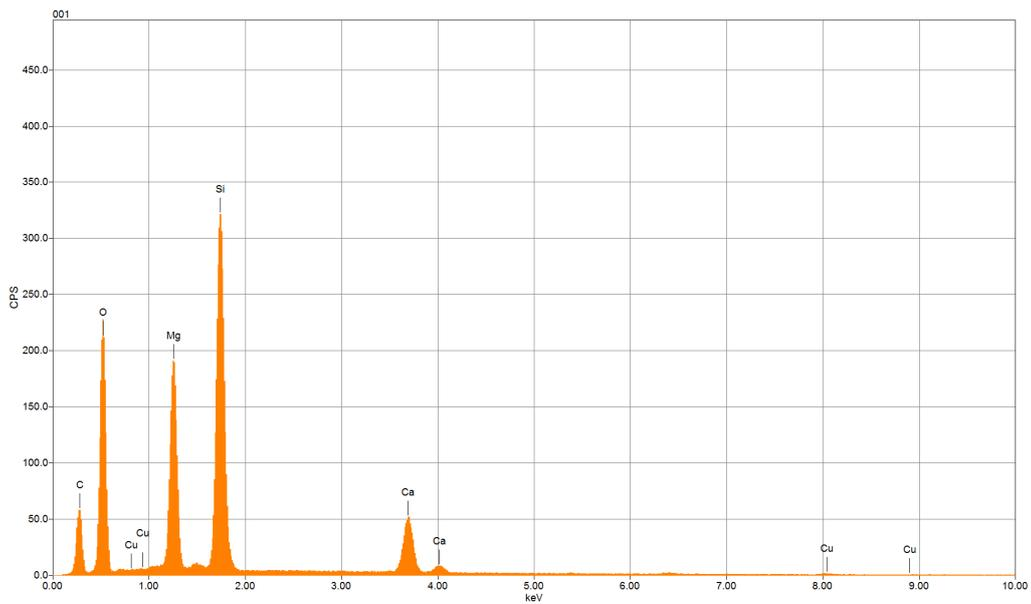
(b) Tremolite asbestos:  $Ca_2(Mg,Fe)_5Si_8O_{22}(OH)_2$
